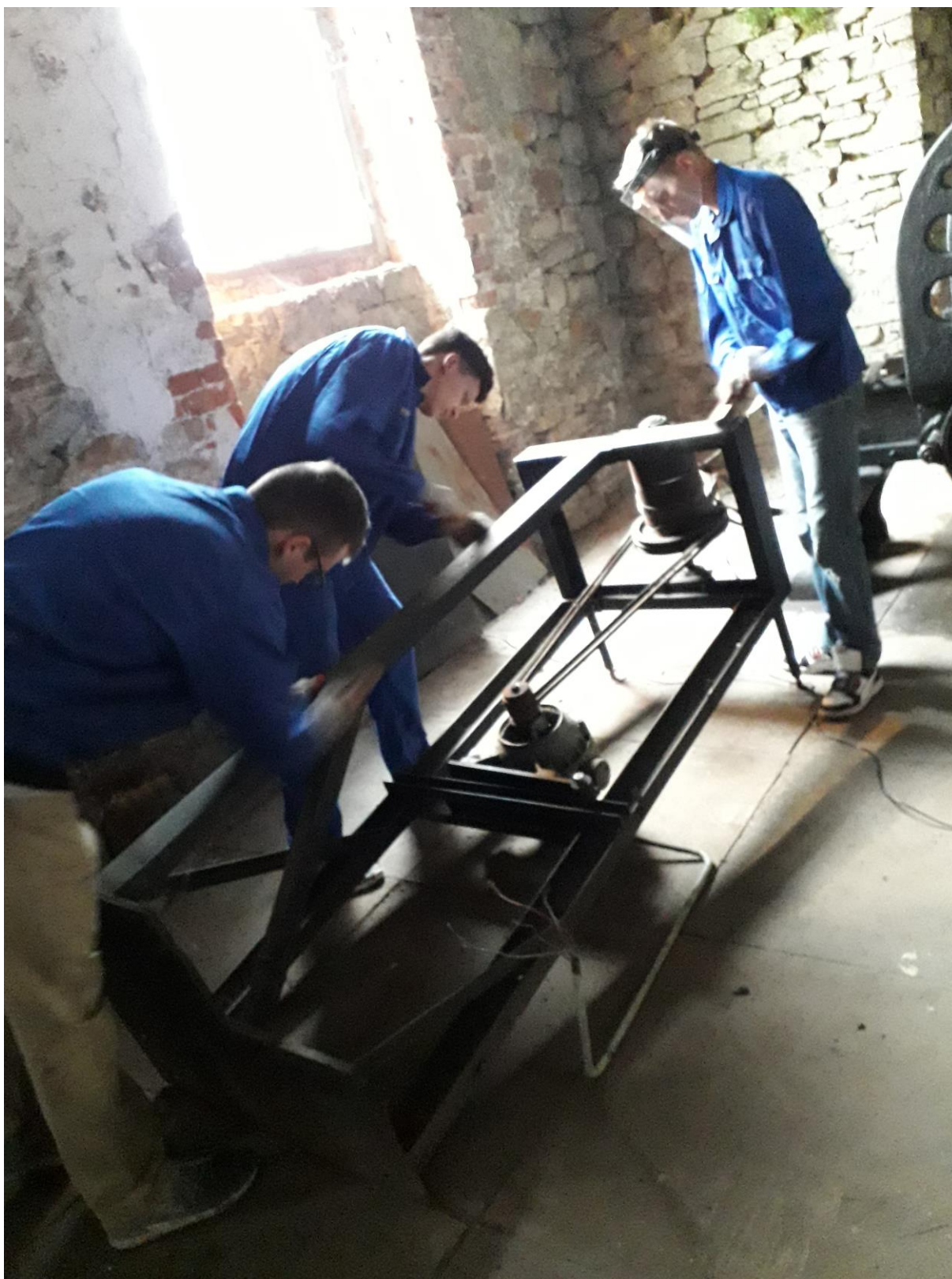
Rys. 16. Czyszczenie i konserwacja elementów konstrukcyjnych z silnikiem od zabytkowej strugarki
