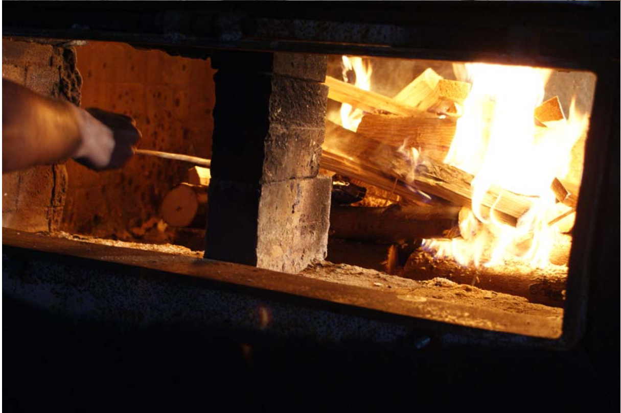
Rys. 11. Rozpalanie pieca pudlingowego
