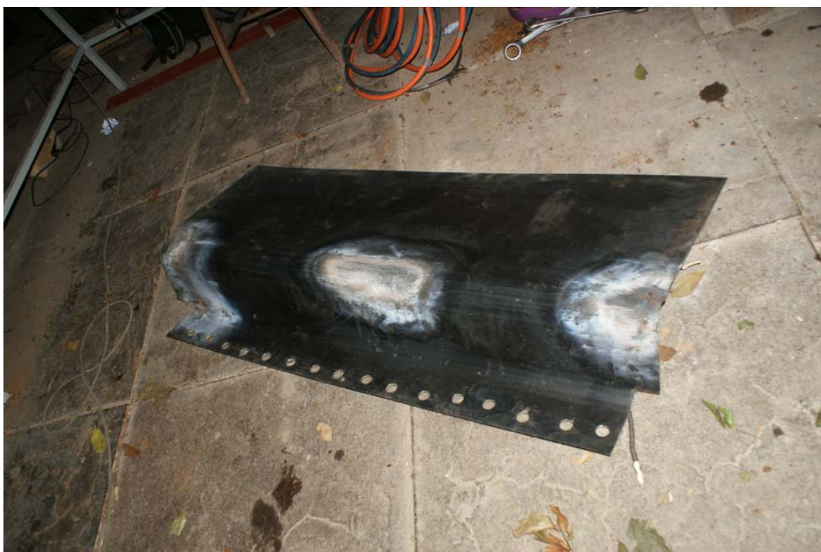
Rys. 2. Widok elementu karczówki nr 56 przygotowanego do wymiany
