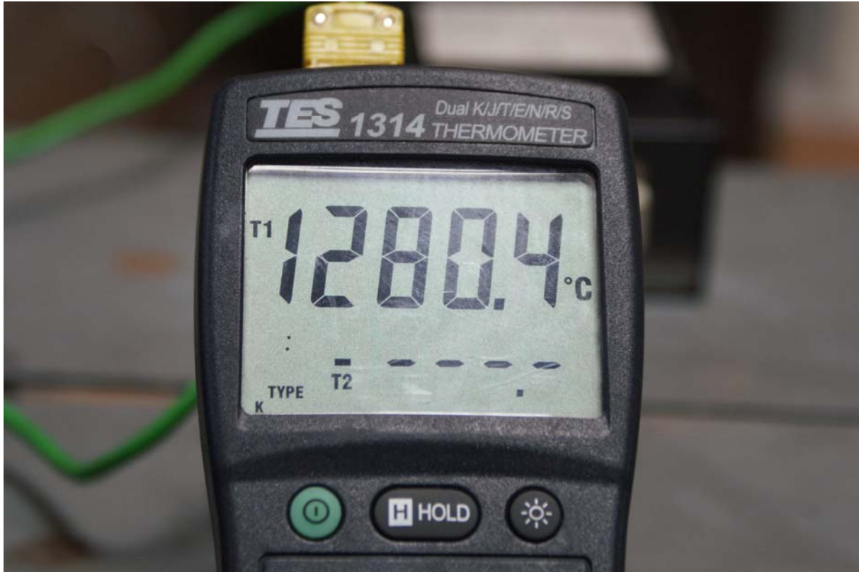
Widok miernika temperatury z osiągniętą maksymalną temperaturą w komorze pieca w trakcie prowadzonych badań
