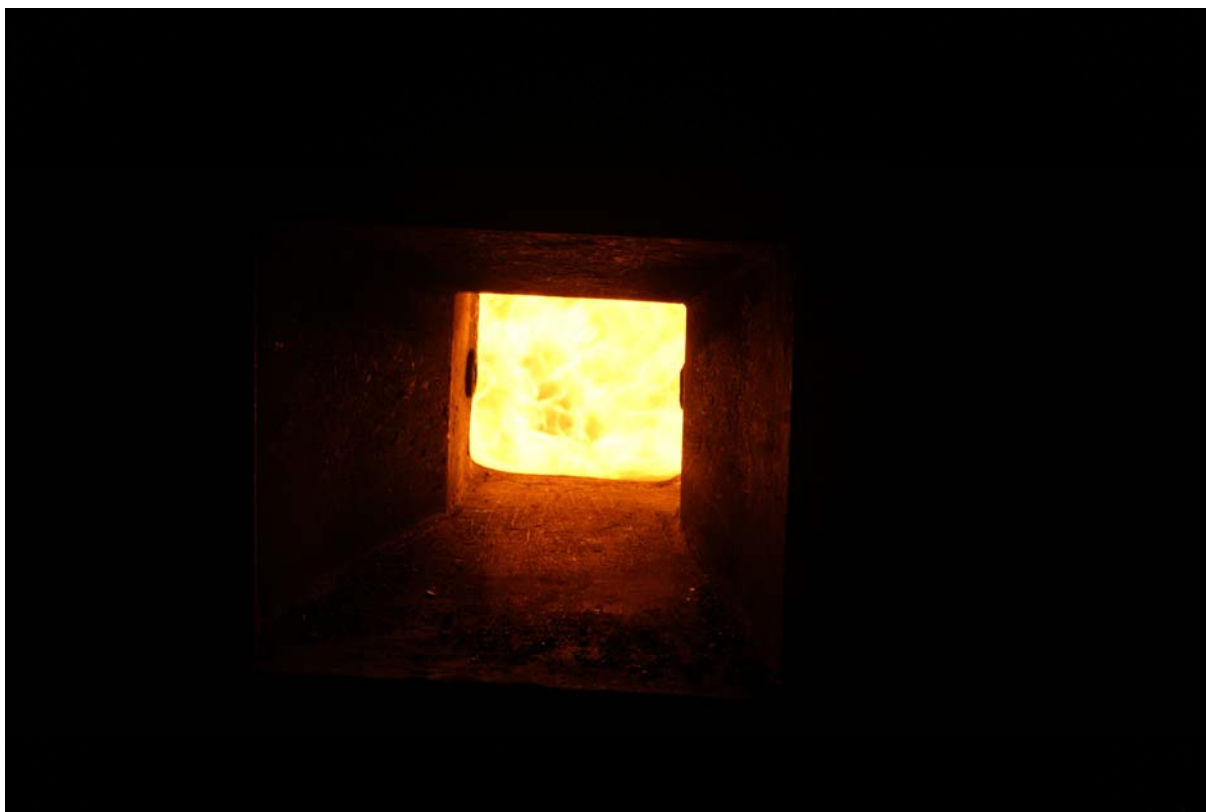
Widok okna załadowniczego w czasie pracy pieca
