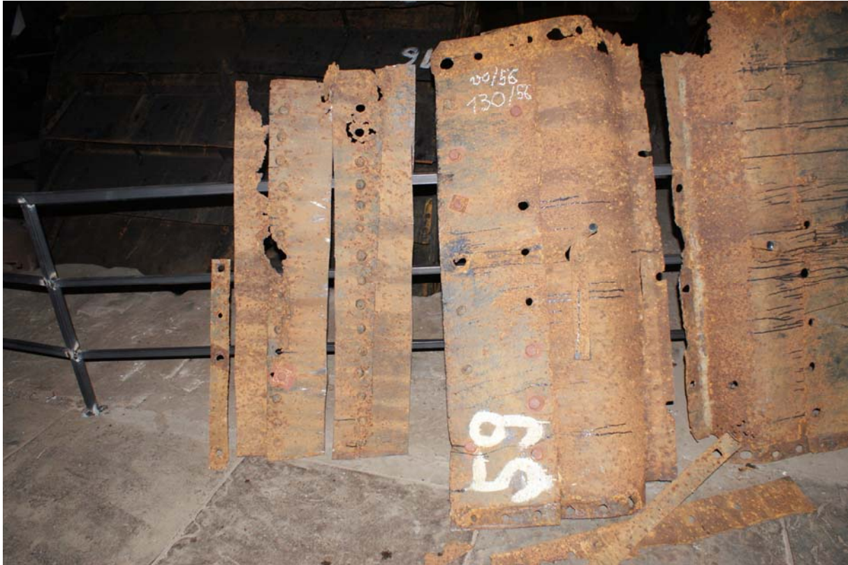
Stare, wymontowane elementy poszycia i karczówki
