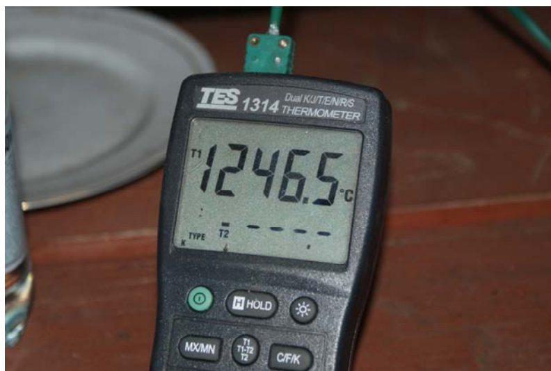
Widok miernika temperatury z osiągniętą temperaturą w komorze pieca
