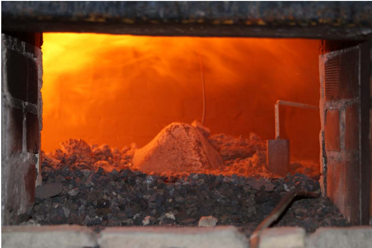
Widok gąski surówki w rozgrzanym piecu pudlingowym
